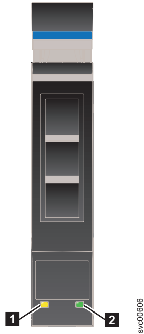
図 14. 単一 2.5 型ドライブの LED インディケータ
