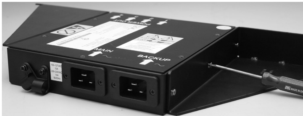
図 302. 取り付けプレートの取り付け
