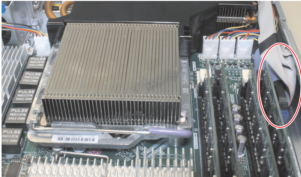
図 276. SAN ボリューム・コントローラー 2145-8A4 システム・ボード上の IDE コネクター
