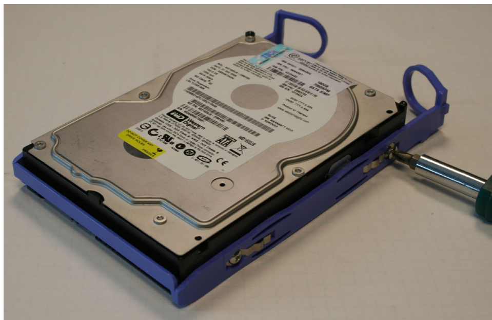
図107. SAN ボリューム・コントローラー 2145-8A4 および SAN ボリューム・コントローラー 2145-8G4 の SATA ディスク・ドライブへのレール・アセンブリーの取り付け
