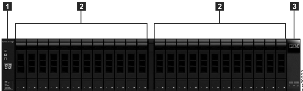
圖 1. 24 個磁碟機和兩個端蓋
