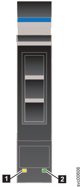
図4. 単一の 2.5 型ドライブの LED インディケーター
