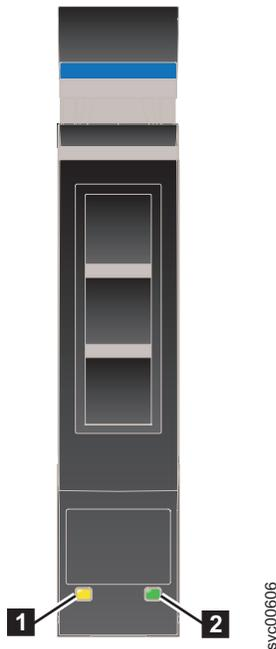
Figura 4. Indicadores LEDs em uma única unidade de 2,5"
