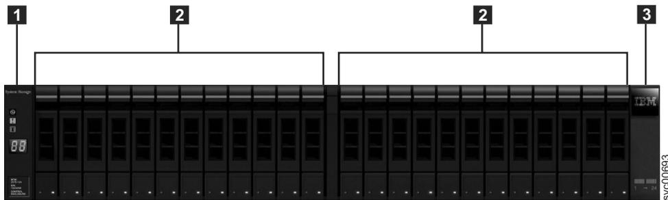
Abbildung 1. 24 Laufwerke und zwei Abschlusskappen
