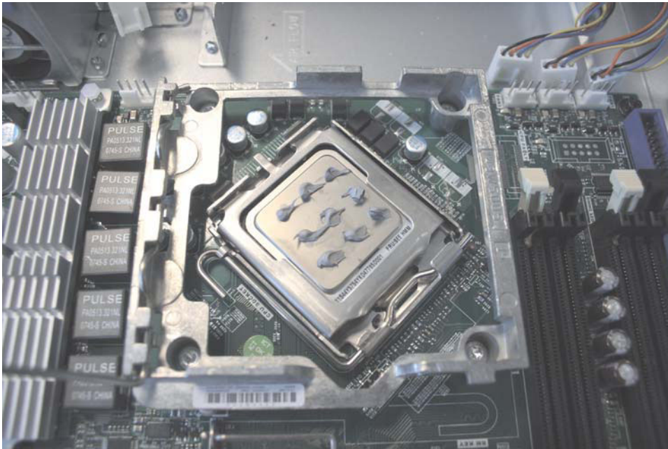
図 267. SAN ボリューム・コントローラー 2145-8A4 マイクロプロセッサ上の 9 個の熱伝導グリース・ドットの全セット
