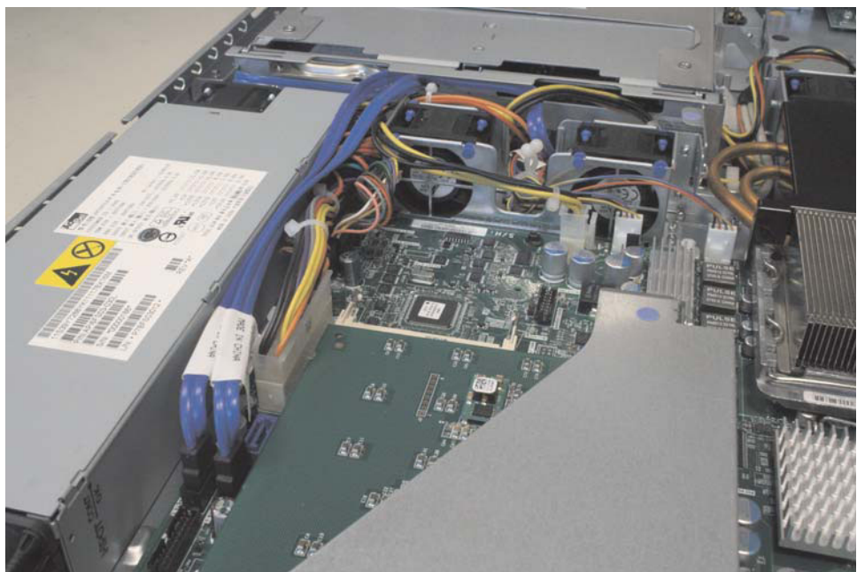
図 128. SAN ボリューム・コントローラー 2145-8A4 SATA ケーブル
