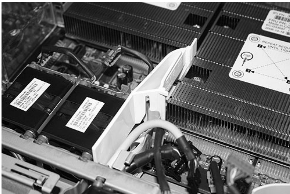
図 282. SAN ボリューム・コントローラー 2145-8G4 の左のエア・バッフル
