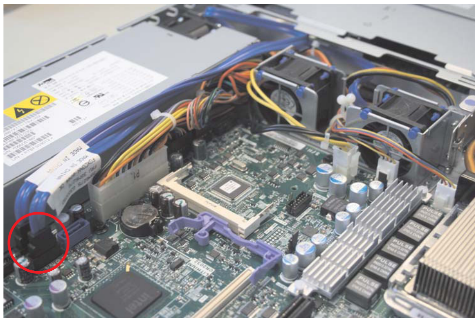
図 276. SAN ボリューム・コントローラー 2145-8A4 SATA ケーブル・コネクタ
