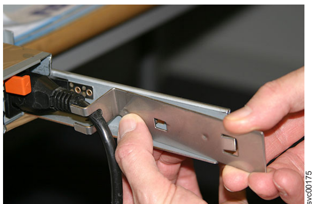
図 32. SAN ボリューム・コントローラー 2145-8F4 電源ケーブルへのケーブル保持ブラケットの取り付け
