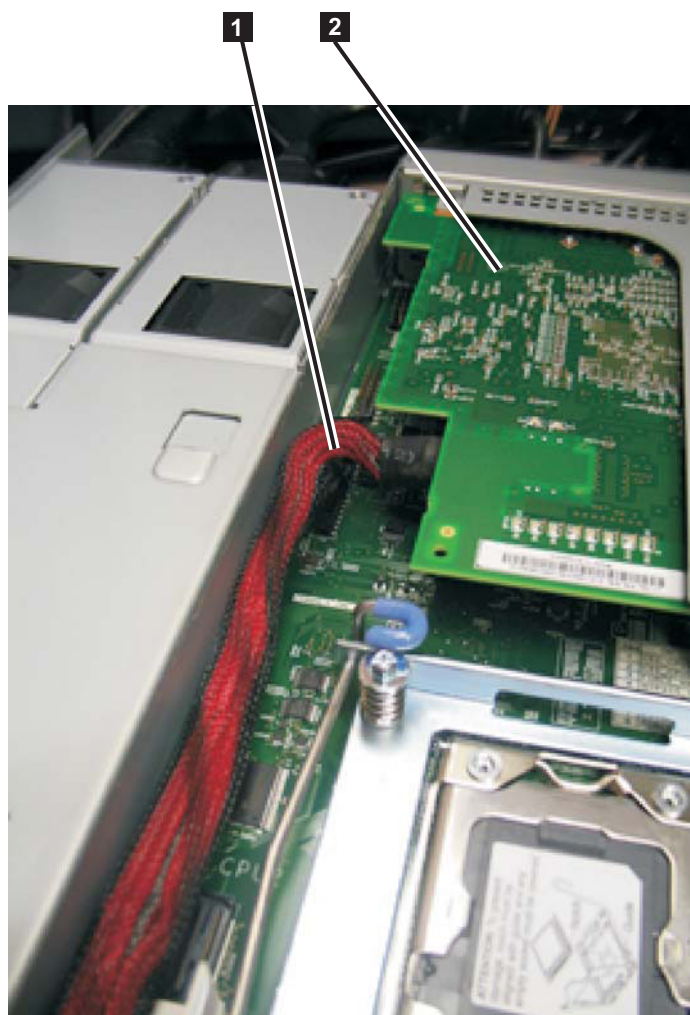
1 図 201. SAN ボリューム・コントローラー 2145-CG8 または 2145-CF8 内の高速 SAS アダプター・アセンブリーおよび高速 SAS ケーブル
