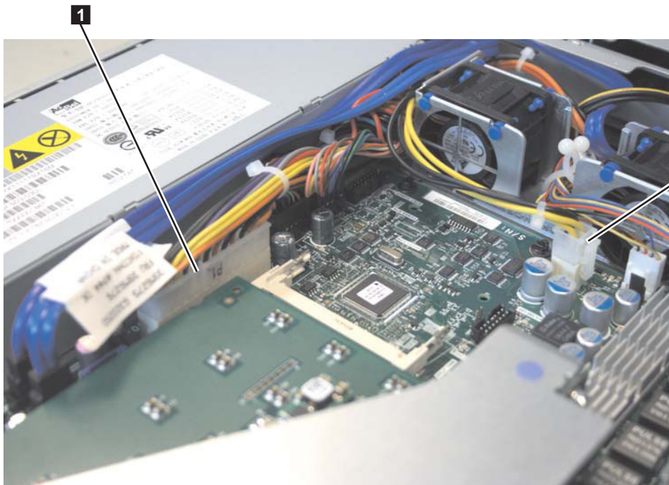
図 158. SAN ボリューム・コントローラー 2145-8A4 システム・ボード上の SATA コネクター
