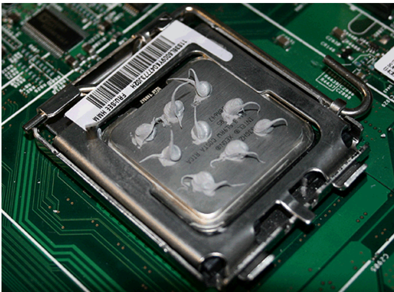
図 299. マイクロプロセッサの熱伝導グリース・ドット (9 個) の完全セット
