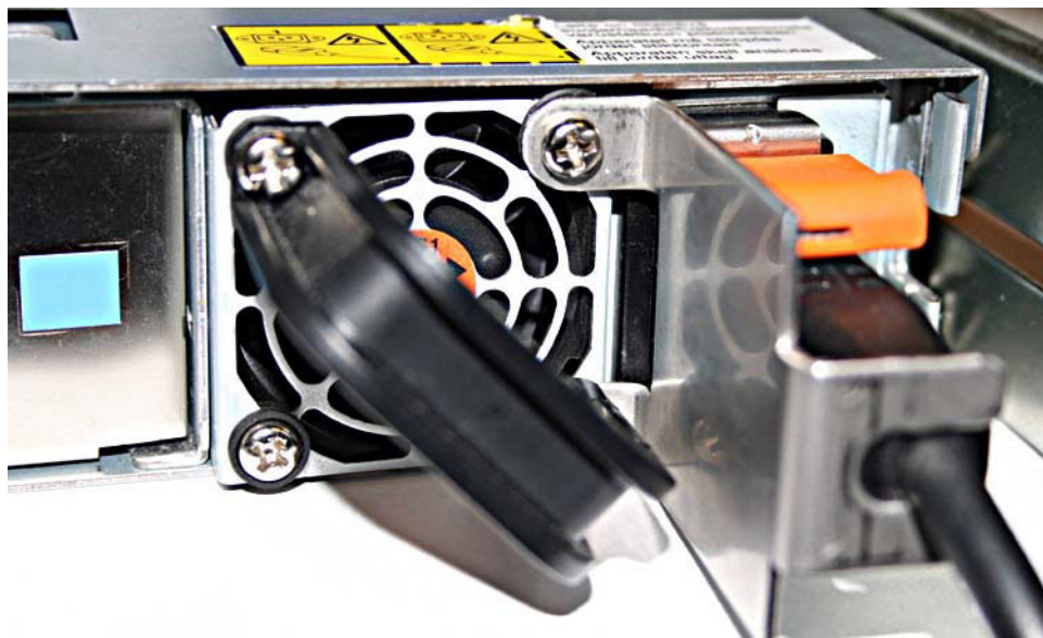
図 22. ケーブル保持ブラケットが取り付けられている SAN ボリューム・コントローラー 2145-8G4
