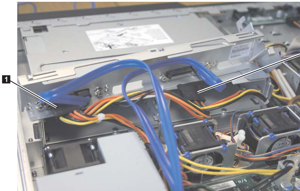
図 118. SAN ボリューム・コントローラー 2145-8A4 電源装置のコネクター
