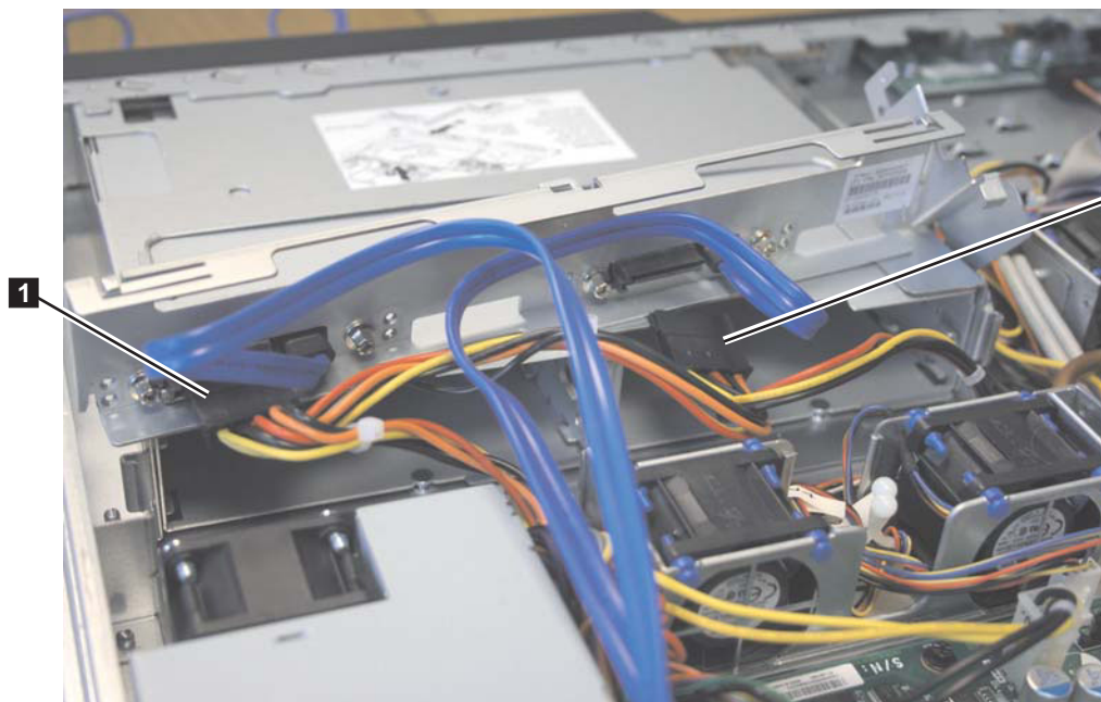
図 127. SAN ボリューム・コントローラー 2145-8A4 電源装置のコネクター
