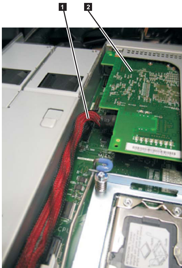
1 図 198. SAN ボリューム・コントローラー 2145-CG8 または 2145-CF8 内の高速 SAS アダプター・アセンブリーおよび高速 SAS ケーブル
