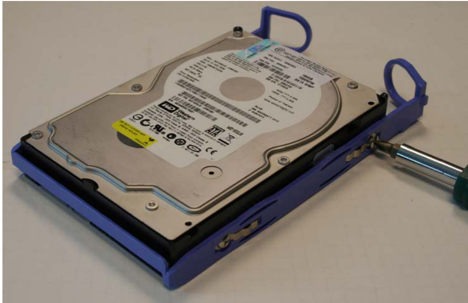
図 109. SAN ボリューム・コントローラー 2145-8A4 および SAN ボリューム・コントローラー 2145-8G4 の SATA ディスク・ドライブへのレール・アセンブリの取り付け
