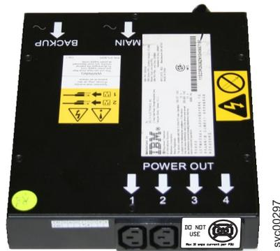
図1. 冗長 AC 電源スイッチの写真
