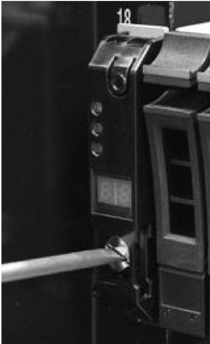
図 11. ラック・キャビネットへのエンクロージャーの固定
