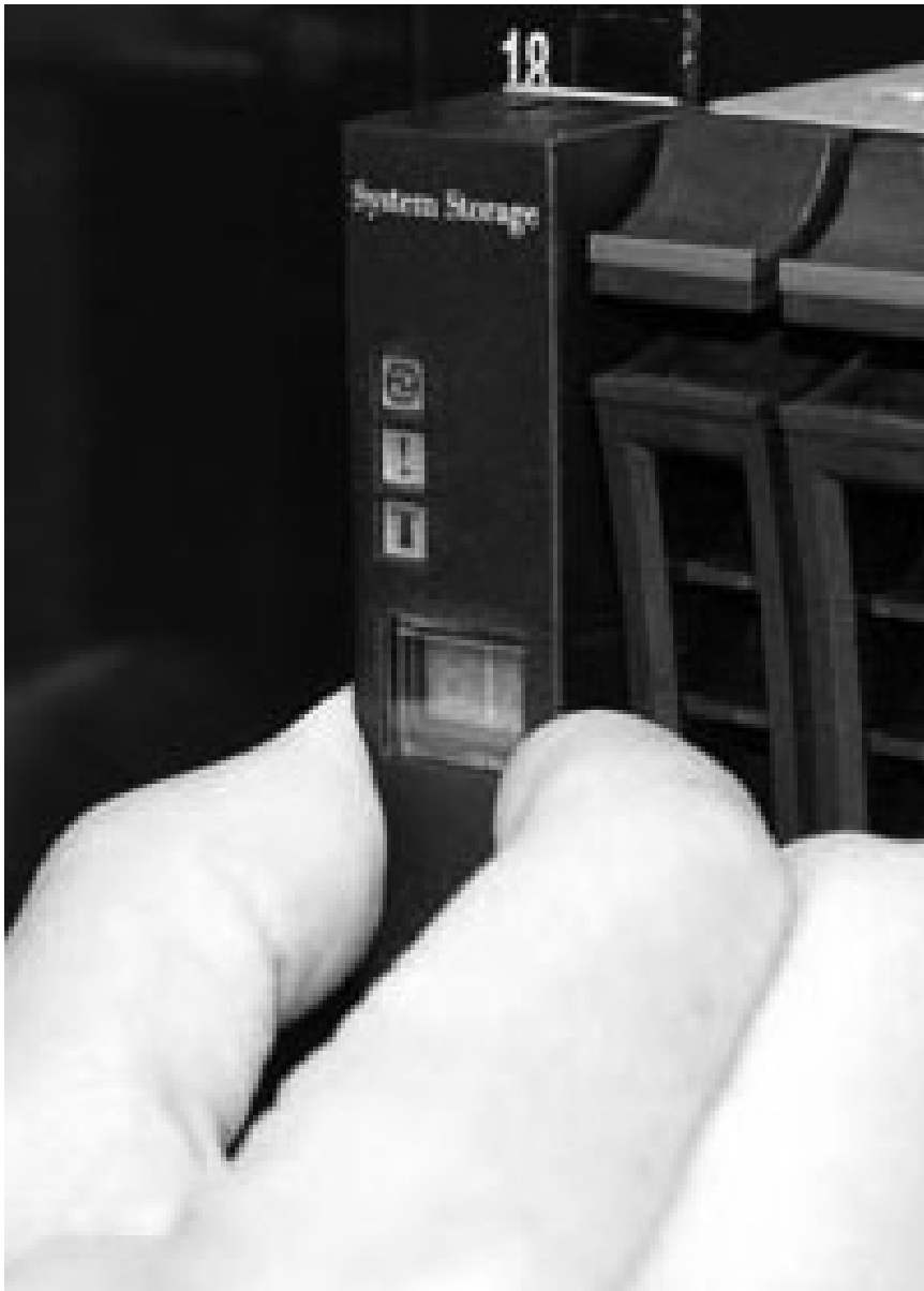
図 10. エンクロージャー・エンド・キャップの取り外し
