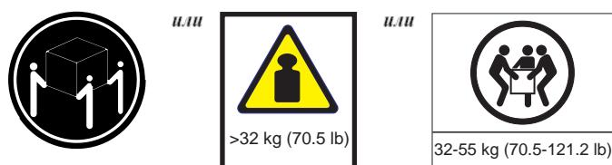
Данный предмет или узел весит от 32 до 55 кг. Поднимать его следует втроём. (C010)
