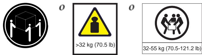
Il peso del componente o unità è compreso tra 32 e 55 kg (70,5-121,2 libbre). Per sollevare in sicurezza il componente o unità, occorrono tre persone. (C010)
