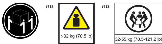
O peso deste componente ou unidade situa-se entre os 32 e os 55 kg. São necessárias três pessoas para mover este componente ou unidade em segurança. (C010)
