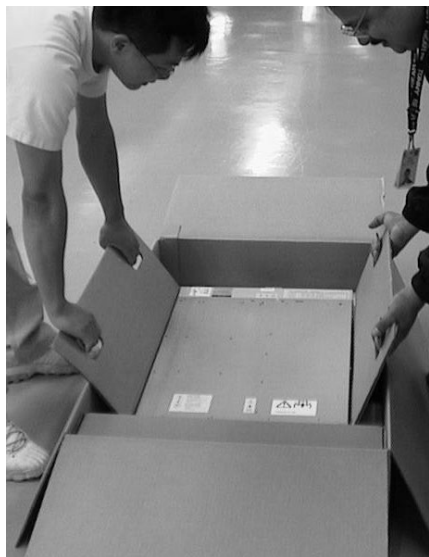
図 292. 2 人で 2145 無停電電源装置 を箱から取り出す
