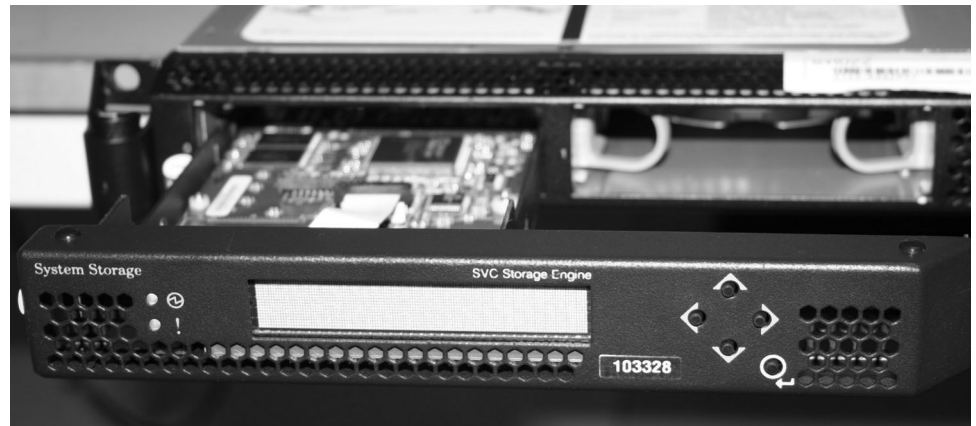
図 143. SAN ボリューム・コントローラー 2145-8G4 サービス・コントローラー
