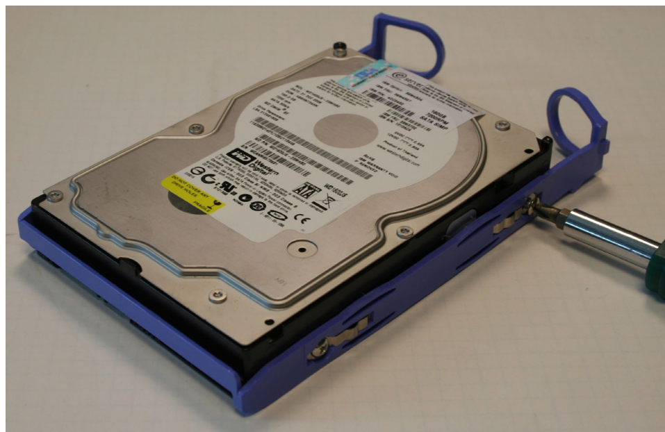
図 165. レール・アセンブリの SAN ボリューム・コントローラー 2145-8G4 SATA ディスク・ドライブへの取り付け
