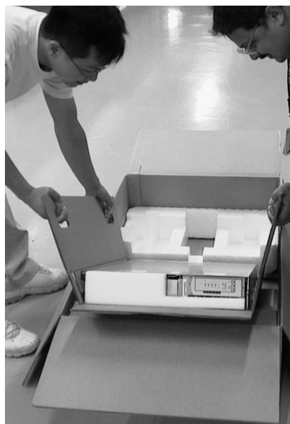
図 293. 2145 無停電電源装置 を箱の端までスライドする
