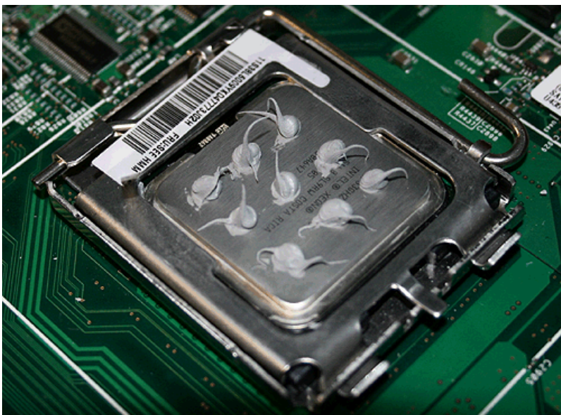
図 248. マイクロプロセッサ上の 9 個の熱伝導グリース・ドットの全セット
