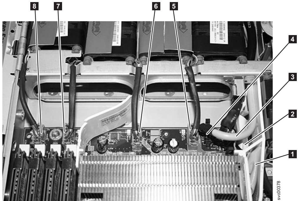
図 250. SAN ボリューム・コントローラー 2145-8G4 システム・ボードの前面右側にあるコネクタ
