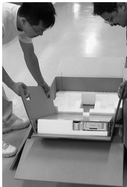
図 107. 2145 無停電電源装置をカートンの端へスライドする
