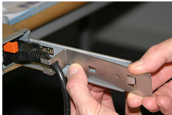
図 80. SAN ボリューム・コントローラー 2145-8F4 電源ケーブルへのケーブル保持ブラケットの取り付け
