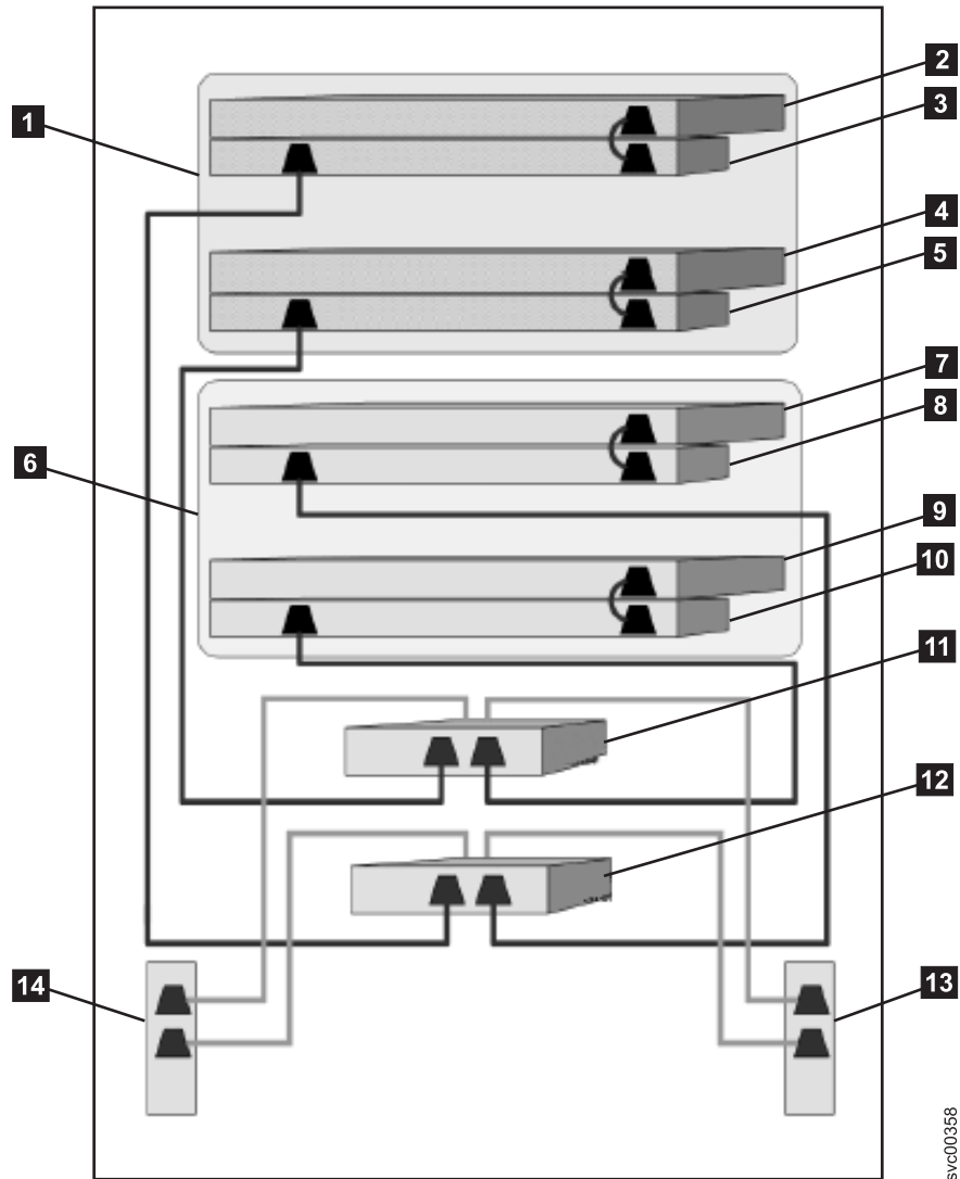
図4. 冗長 AC 電源スイッチ機構を備えた 4 ノード SAN ボリューム・コントローラー・クラスター
