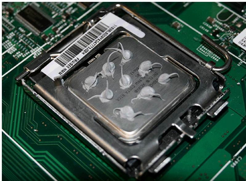
図 214. マイクロプロセッサ上の 9 個の熱伝導グリース・ドットの全セット
