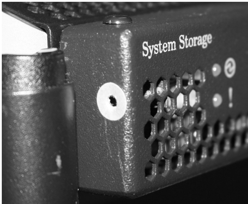
図 98. SAN ボリューム・コントローラー 2145-8G4 サービス・コントローラー・リリース・ボタン
