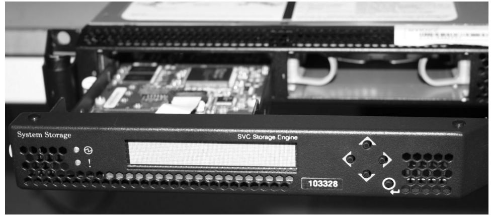
図 92. SAN ボリューム・コントローラー 2145-8G4 サービス・コントローラー
