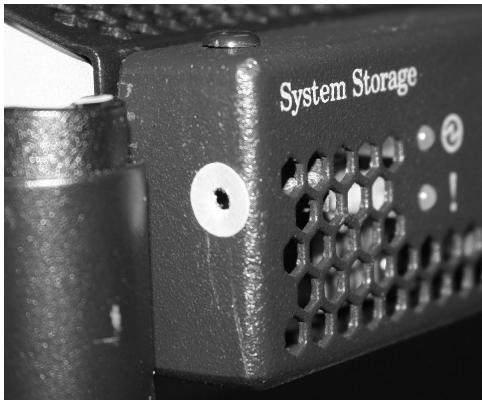
図 85. SAN ボリューム・コントローラー 2145-8G4 サービス・コントローラー・リリース・ボタン
