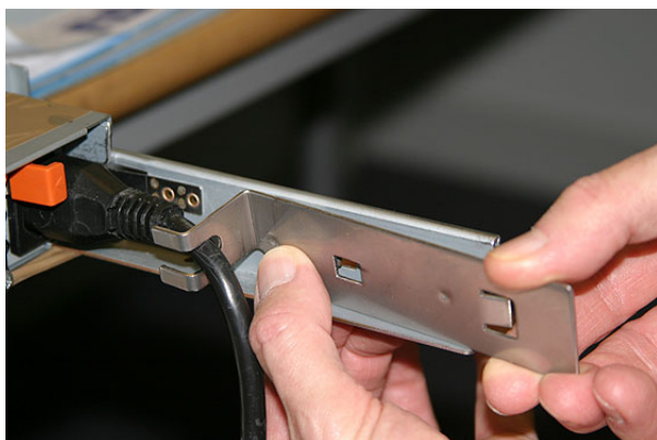
図 46. SAN ボリューム・コントローラー 2145-8F4 電源ケーブルへのケーブル保持ブラケットの取り付け
