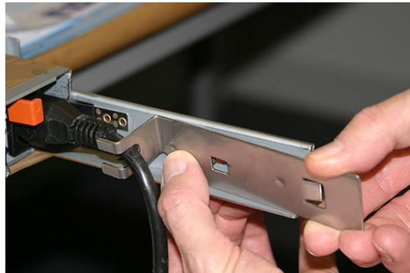
図 13. SAN ボリューム・コントローラー 2145-8F4 電源ケーブルへのケーブル保持ブラケットの取り付け
