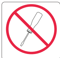
図 2. SAN ボリューム・コントローラーのユーザー・アクセス禁止ラベル
