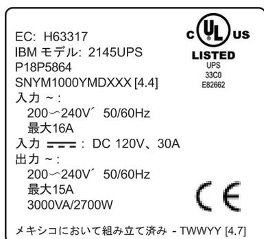
図6. 無停電電源装置の機関ラベル
