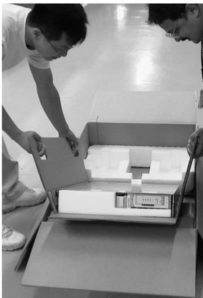
図 118. 無停電電源装置を箱の端までスライドする
